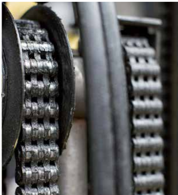
Le catene Fleyer vengono utilizzate soprattutto per il sollevamento. A differenza delle catene a rulli, sono formate solamente da piastre tenute insieme dal perno
